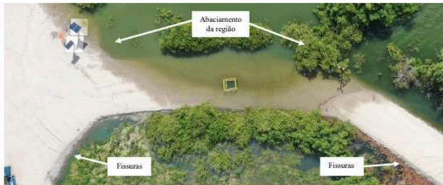
Figura 56 – Fissuras na região da Mina 18D, em imagem aérea registrada pela Perícia em 06/12/2023.
